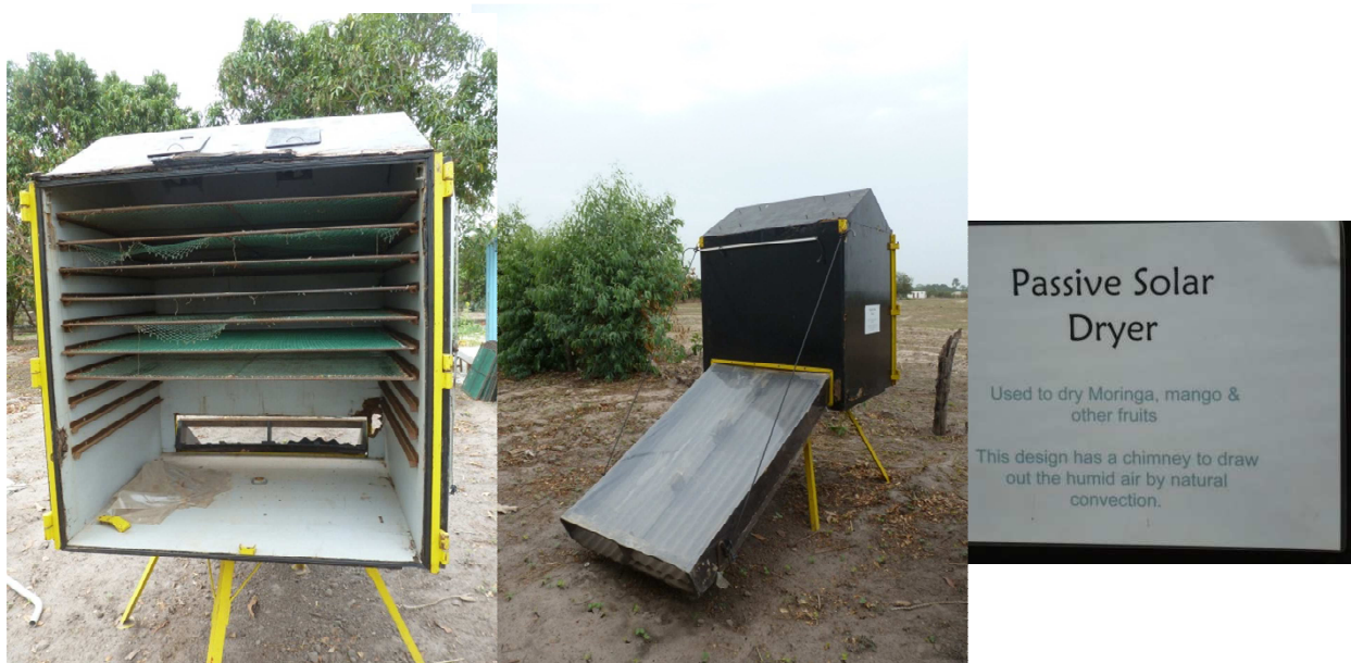
Abb. 11: Solartrocknungsanlage der NGO „Gambia StartUp“ Quelle: eigene Darstellung
